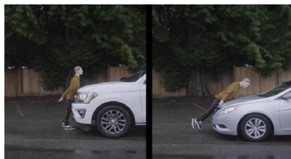
Figure 4 Impact d'un choc frontal sur un piéton : Comparaison VUS/berline
